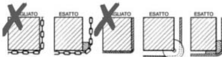
Protezioni per catene e funi in corrispondenza di spigoli del carico
